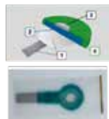
フィルム状銀塩化銀参照電極の構造(上)と外観(下)
