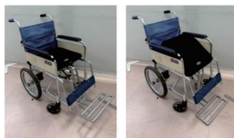
(a)乗車時 (b)起立時 図1 移乗補助装置の設置の状態
