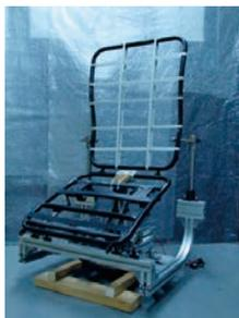
図2 起立支援機構の試作機
