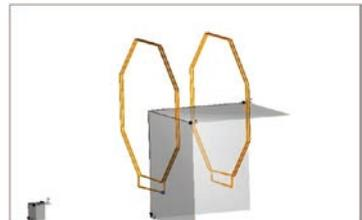
図2 送受電コイルの解析モデル
