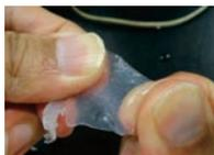
間伐材から製造した多孔質材料
