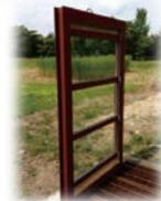
電波吸収体の曝露試験
