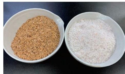
図1 籾殻からの非晶質シリカの抽出 (右: 籾殻 左: 非晶質シリカ)
