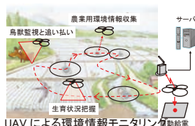
図 2 UAV による環境情報モニタリング(自動給電)
