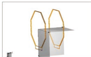
図2 受電コイルの解析モデル
