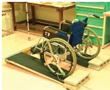
図1 操作力計測用の車いす
