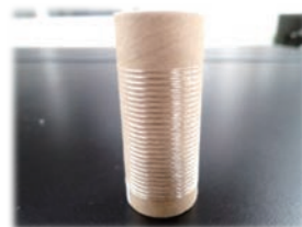
図3 イオン液体を含むことで得られた乾式シルク繊維
