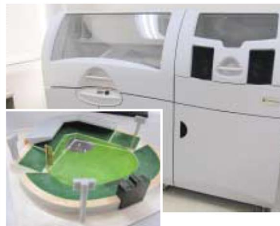
三次元造型機 (ZPrinter 650) と作品 (野球場)
