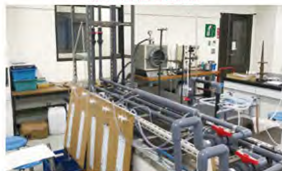
管内流動 実験設備
