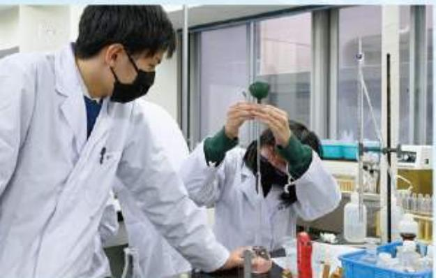
事前に調製した塩基(濃度が決定している水酸化ナトリウム水溶液)を用いて、酸(工業用硫酸を希釈した溶液)の濃度を決定しており、その体積を正確に測るために、標点(器具の目印)に合わせて溶液を計測する必要があります。酸と塩基がちょうど同じになる(中和点、当量点)とされる際は特別な指示薬を用いて確認しますが、写真のように淡いピンク色の状態になります。
