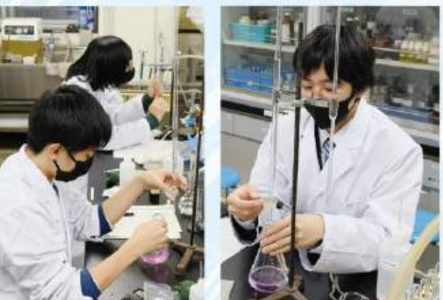
この実験のポイントはピュレットを使って溶液を微量に滴下して中和点を見極めることです。
