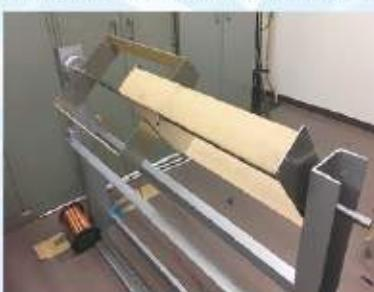
風速を90%減速して発電する風力発電機
