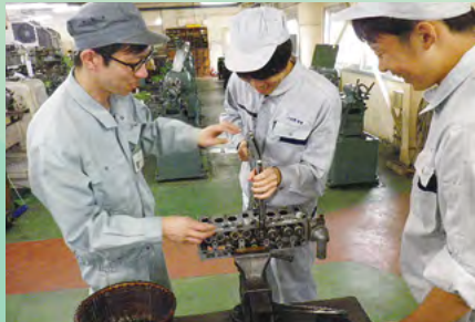
↑学生実習・実験・研究支援の様子 高専らしい実験・実習・研究支援の一翼を担っています。写真は、機械系4年生実習「エンジンの分解・組立・試運転」
