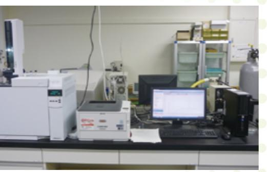
図2 新型ガスクロマトグラフ(Agilent 7820)
