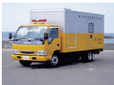
図1 応急用電源車(400KVA)
