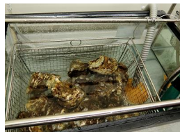
マイクロバブルによるカキの洗浄実験(左)、マイクロバブル装置の概要(右)
