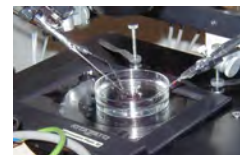
左：受精卵呼吸量測定装置，中央：ウシ胚盤胞の呼吸量測定（胚の上がマイクロ Pt プローブ），右：ウシ初期胚の膜電位測定
