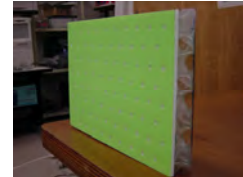
パネル状吸音装置
