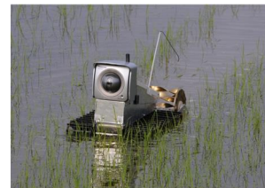
設計製作した水田用除草攪拌機
