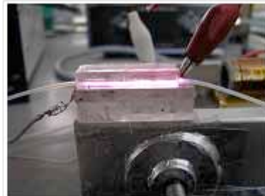
テフロンチューブ内壁処理
