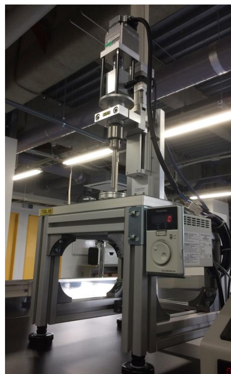
ソフトマテリアルリング用 摩擦測定装置
