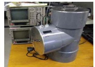
図4 音響式体積測定装置
