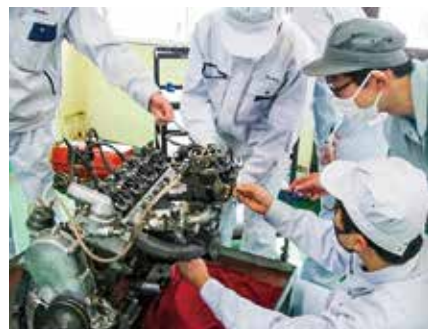
エンジン分解の様子（工学実験・実習Ⅲ）
