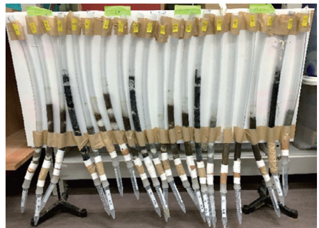
写真1 各種土壌と各種カルシウムの関係調査
