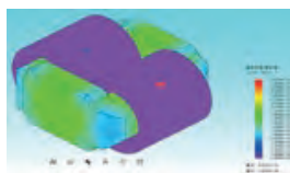
図5 チョークコイルの磁界解析
