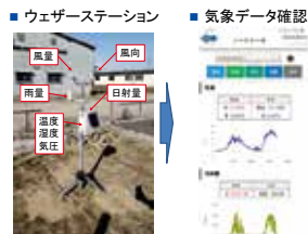
図3 KOSEN版ウェザーステーションとデータ確認
