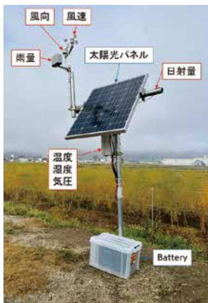
図1 電源の確保ができない場所に設置したウェザーステーション
