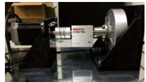
図3 発電機の出力特性測定装置
