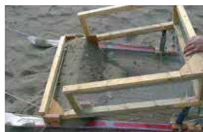
図3 試作したマイクロプラスチック回収装置
