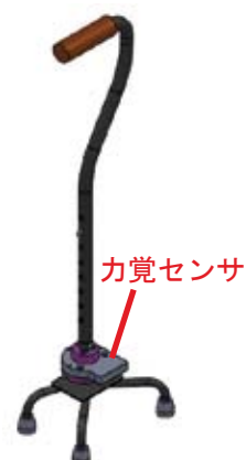
図2 計測用の多脚杖
