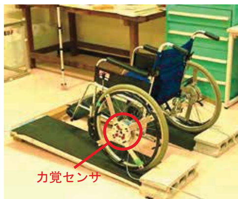
図1 操作力計測用の自走式手動車いす
