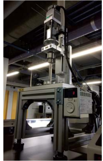
ソフトマテリアルリング用 摩擦測定装置
