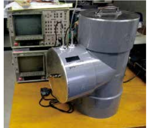
図1 製作した音響式体積計
