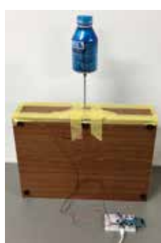
図2. 試作した気象予測システムのセンサ部とWi-Fiモジュール部
