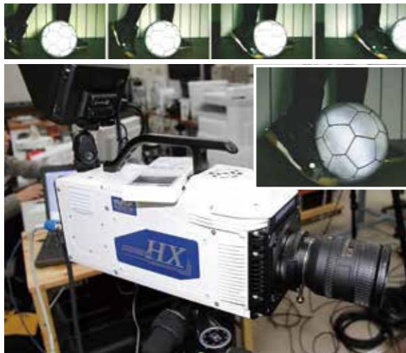
ナック社製高速度カメラとボールキック瞬間の連続写真
