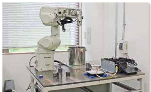
ロボットを利用した部品加工テスト機
