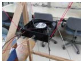
図2 小型軸流ファンの振動計測
