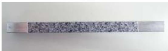
図4 画像関連法による計測を容易にするためのパターンシールを貼付した試験片
