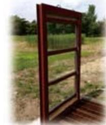
電波吸収体の曝露試験
