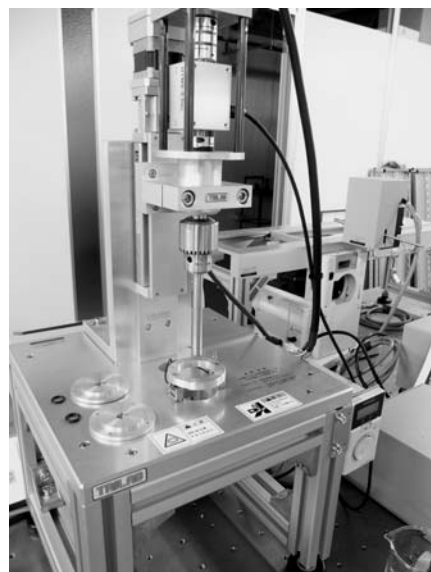
ゲルシール材の評価に特化した摺動・回転トルク同時測定装置
