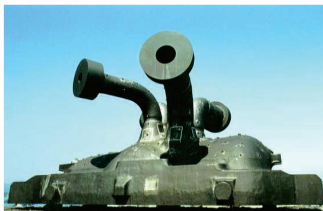
火力発電用高圧外部車室(高圧タービンケーシング)
