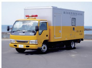
図1 応急用電源車(400kVA)
