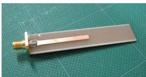
図1 製作した平面導波路
