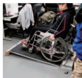
傾斜面における車いす 操作力の計測の様子
