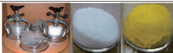
(左)ボールミル装置を用いた (中)紫外光応答触媒を原料とする(右)可視光応答触媒の合成
