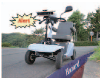
図1 ハンドル型電動車いすにおける 危険検出の例
