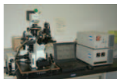
左：受精卵呼吸量測定装置，中央：ウシ胚盤胞の呼吸量測定（胚の上がマイクロ Pt プローブ），右：ウシ初期胚の膜電位測定
