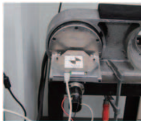
6軸加速度センサによる 3次元運動の計測の様子
