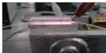
2) テフロンチューブ内壁のプラズマ処理
