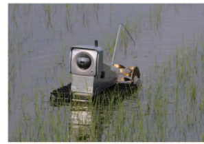
設計製作した水田用除草攪拌機
