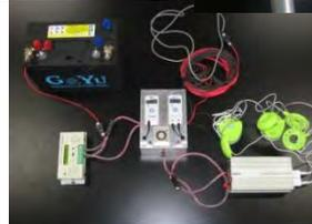
図 1. 風力発電を活用した温室での電照栽培教材
