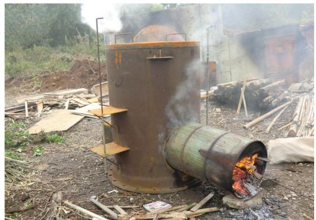
写真 1 製造した炭焼き窯の外観
