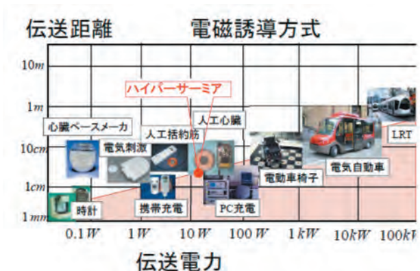
図1 伝送電力と伝送距離実証値(電磁誘導)
