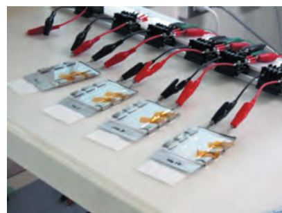
薄型リチウムイオン電池の充放電試験のようす
