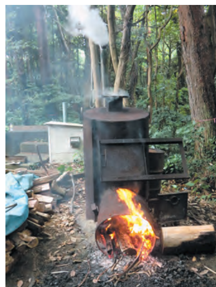
写真2 飛島での流木炭化
