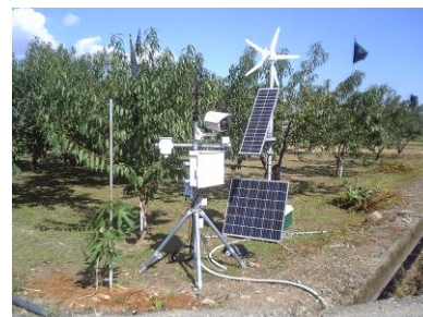
フィールド・モニタリングシステム
