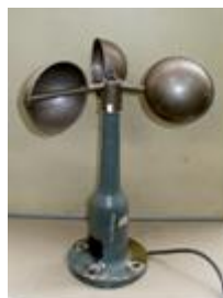
三杯式風速計
