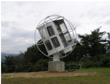
世界初?の斜軸風車(眺海の森)
