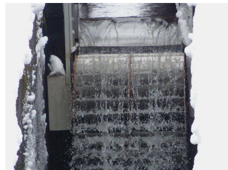
農業用水路で試験中の水車
