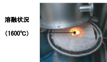
図2 電磁誘導連続溶融装置
