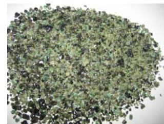
図3 青石綿の溶融急冷物
