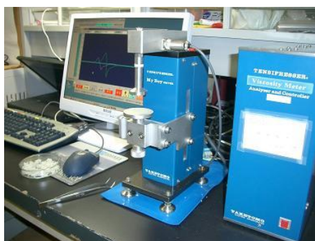
図4 テンシプレッサーと測定結果イメージ（独）農研機構 食品総合研究所
