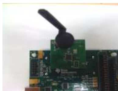
図 2 TI ZigBee 評価キット
