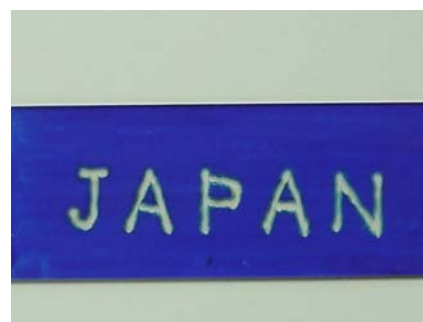
図3 油性インクの局所剥離
